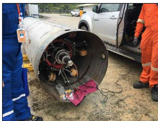
รูปที่ 2-20 การตรวจสอบการกักตัวของผิวภายในท่อด้วยการปล่อยกระสวย (Intelligent PIG)
