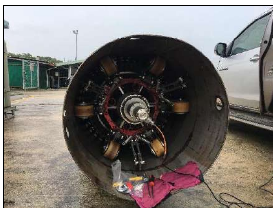
รูปที่ 2-20 การตรวจสอบการกักตัวของผิวภายในท่อด้วยการปล่อยกระสวย (Intelligent PIG)
